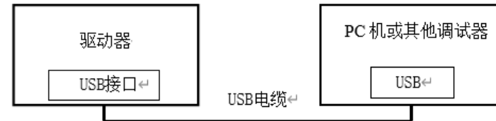
参数调试接线示意图
